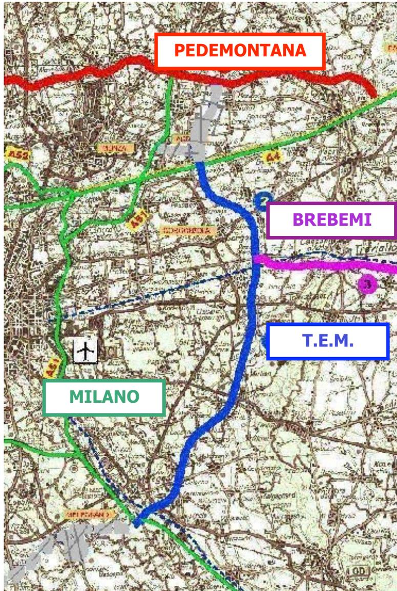
**TRACCIATO:** 62 km in autostrada di 38 km a raso e 19 in trincea, correndo in gran parte parallelo all'Alta Velocità ferroviaria e connettendosi a Liscate (MI) con la T.E.M.
